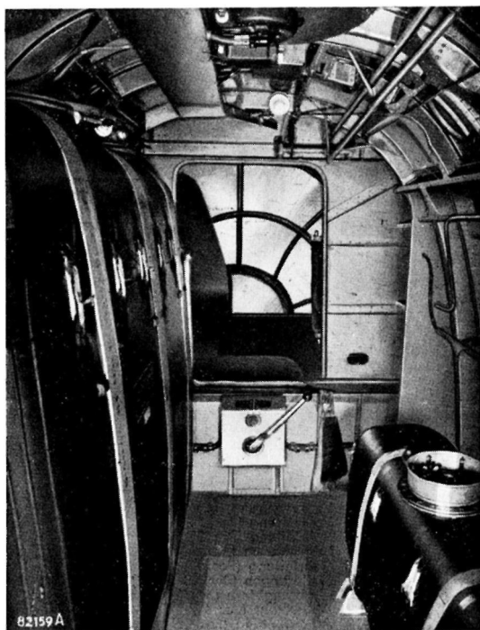
Abb. 11: Kraft- und Schmierstoffvorratsbehälter im Lastenraum
