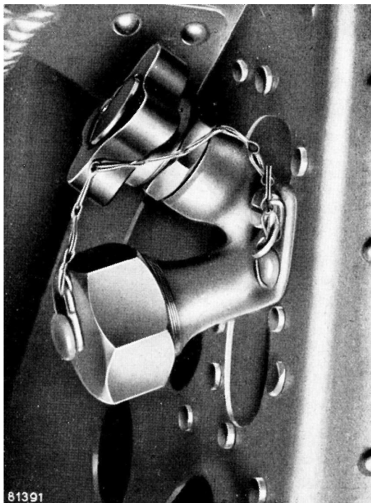
Abb. 7: Ansicht vom Außenbordanschluß
