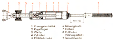
Abb. 12 Spindelwelle mit Öl-Stoßdämpfer
