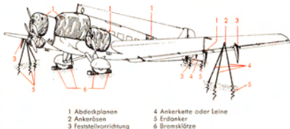
Abb. 32 Verankerung und Abdecken des Flugzeuges
